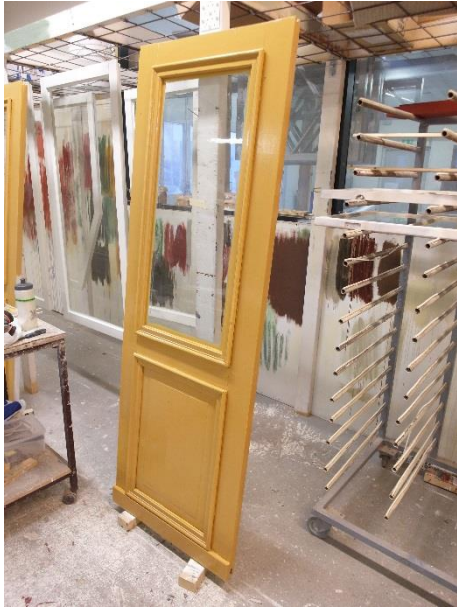
Innerdörr stuken med järnoxidgult S 3050 – Y 20R. Gångjärn före rostskyddsbehandling.
