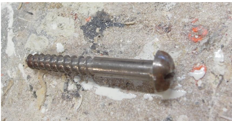
Dörrarna sitter nu upphängda med spårskruv.
