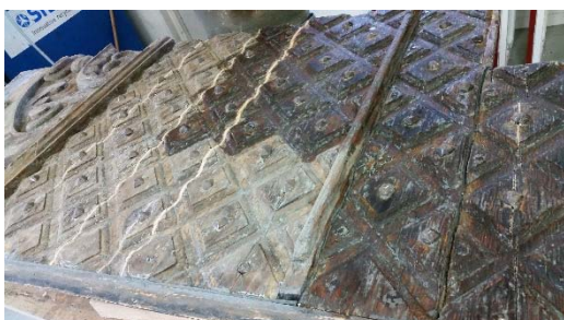
Halvoljning och grundmålning. Foto Fönster & Hantverk.
