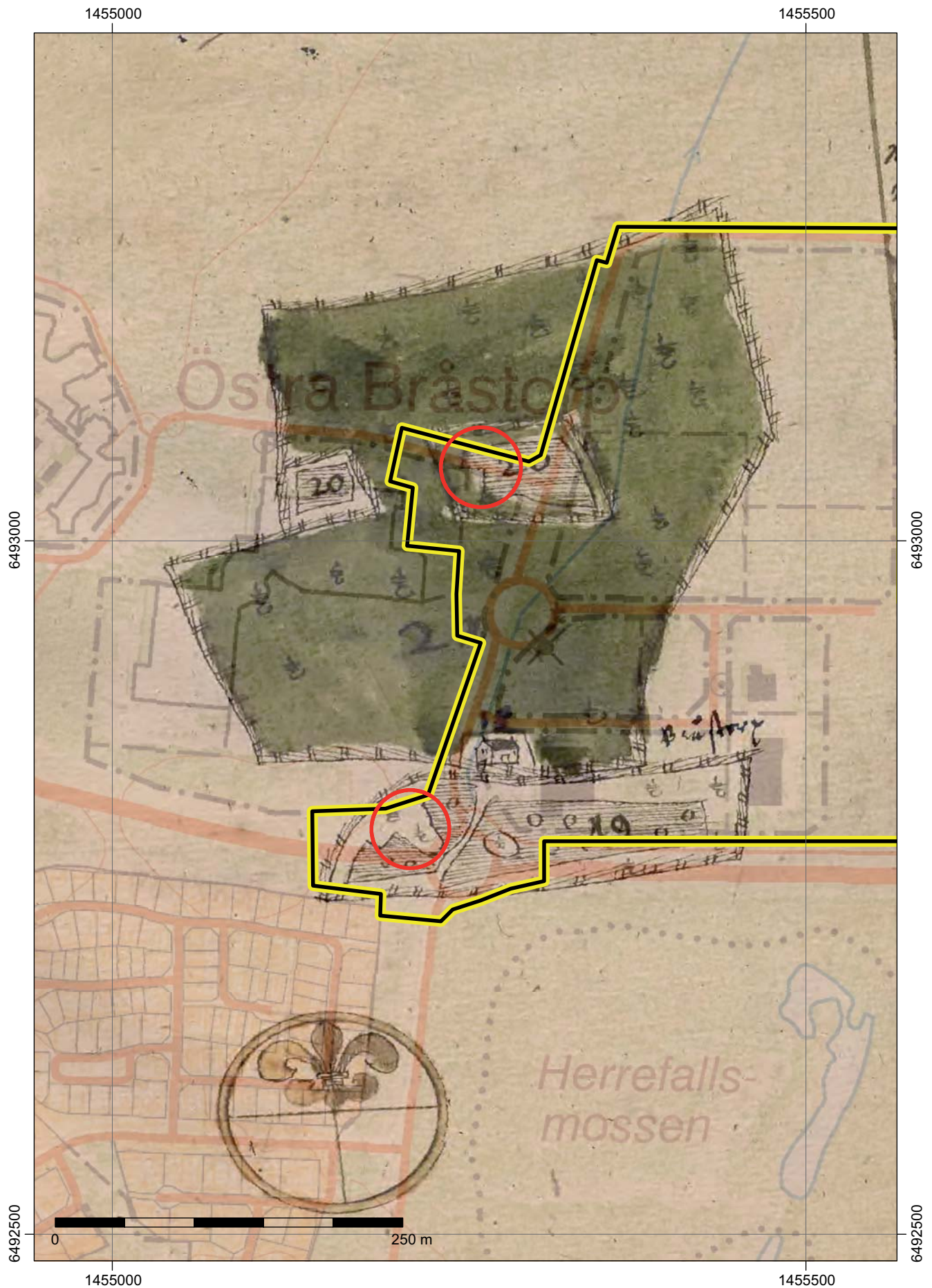
Figur 6. Försök till rektifiering av utsnitt ur geometrisk ägoavmätning över Bråstorp kronohemman från år 1636 (LMS, akt D71-15:D5:225) med den digitala fastighetskartan i bakgrunden. Lantmäteriakten har rektifierats mot den häradsekonomiska kartan över området och de detaljer som tydligt framträder och som rektifieringen i huvudsak grundar sig på är markerade med röda cirklar. Den tidiga lantmäteriakten visar i en jämförelse med den häradsekonomiska kartan tydligt att gården vid någon tidpunkt flyttats västerut.
