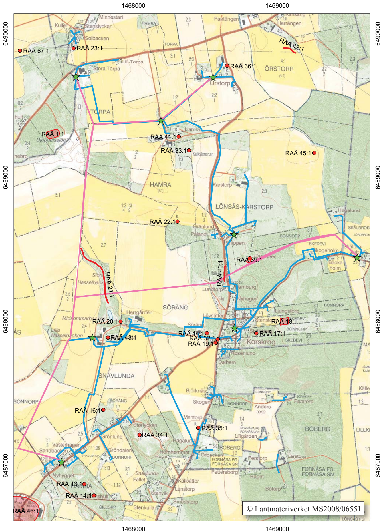
Figur 2. Utdrag ur digitala Fastighetskartan, blad 8F7d och 8F8d, med undersökningsområdet markerat. Blå linje markerar grävning för ny kabel, rosa linje markerar rasering av befintlig luftledning. Skala 1:15 000.
