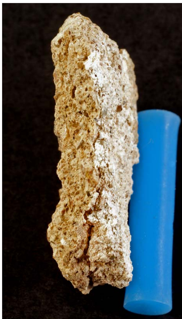
Figur 12. Murbruksprov taget ur kalkstenshuset vid undersökningarna av Västra fasaden, Linköpings slott 1996. Brukstyp 2A. Sprickan mellan de två sorternas bruk syns tydligt. Foto Lasse Norr, ÖLM.
