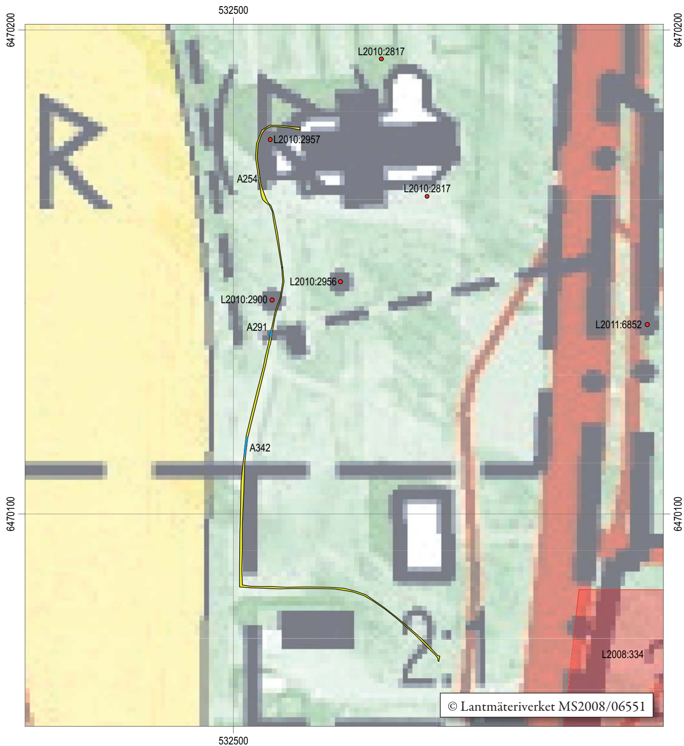
Figur 4. Schaktplan. Notera att runstenarna L2010:2956 och L2010:2900 har felaktig position och står ca 10 m åt Ö. Skala 1:800.
