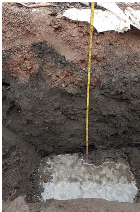
Figur 17. Ett djupare provhål öppnades med maskin i den södra delen av Schakt 1. Mot botten av hålet framkom orörd undergrund och grundvatten trängde upp snabbt. Se profil 1318. Mot sydost. Foto Emma Karlsson, ÖM.
