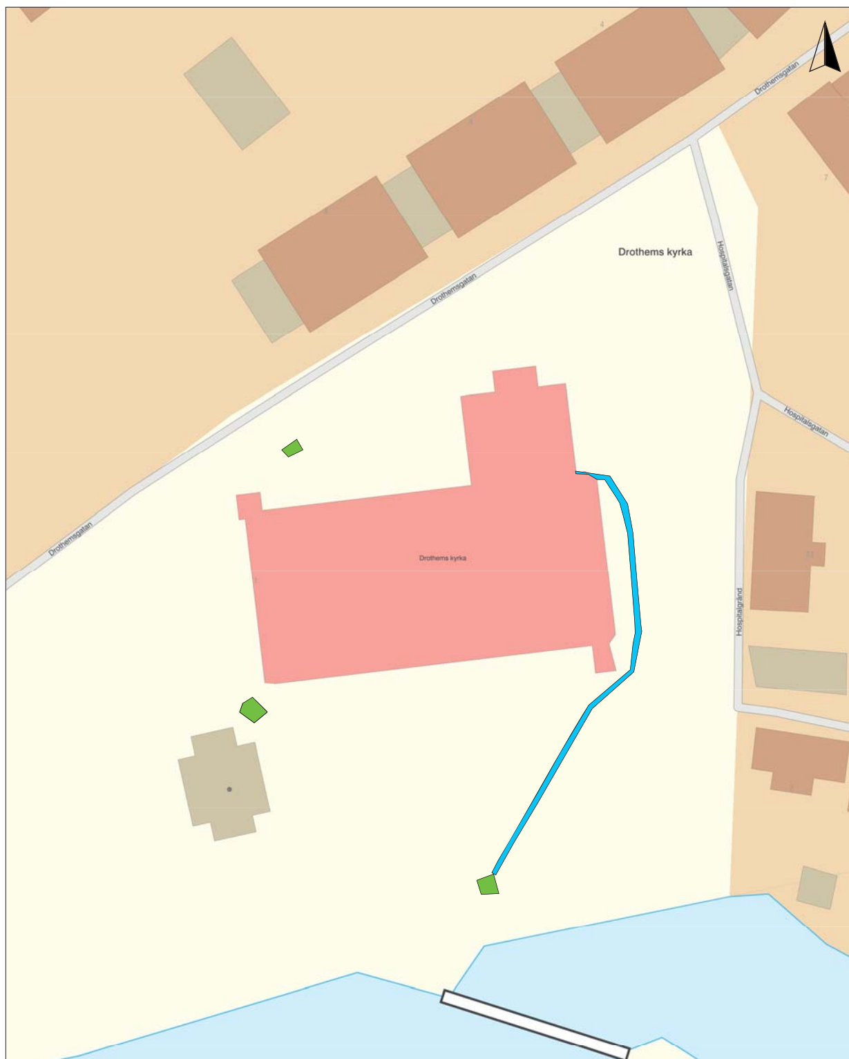
Figur 7. Tre mindre schakt togs först upp för att lokalisera var i ledningarna stoppet satt (gröna polygoner). Ett längre schakt drogs sedan upp från kyrkans östra gavel och vidare ut i anslutande gräsmatta (blå polygon). Skala 1: ???
